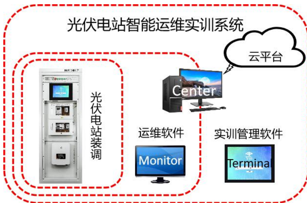
图 1.1 光伏电站智能运维实训系统
