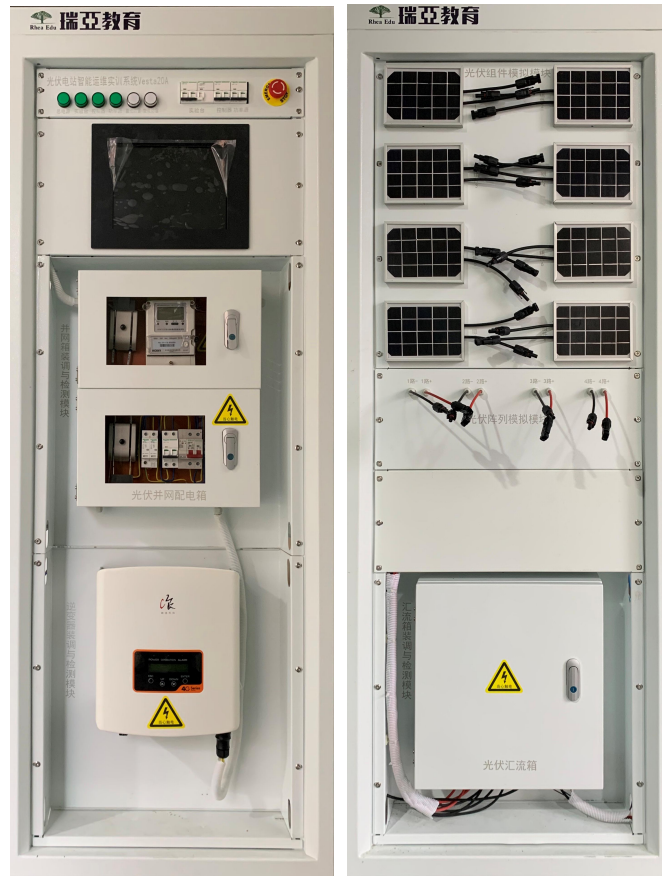
图 2.1 光伏电站装调实训平台
